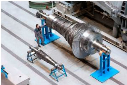
(MDT_2.jpg) Zweistufiges Turbinenkonzept: Ähnlich wie hier liefert MAN eine Dampfturbo-Gruppe, bestehend aus Hochdruck- und Niederdruckturbinen, nach Japan.
